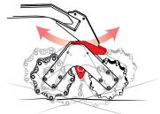
PIVOTING ROLLER FOR BETTER SOIL LEVELLING
